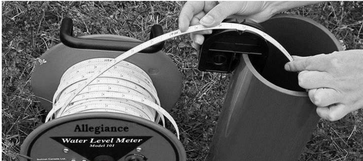
Figura 35. Sonda para medición de nivel dinámico. Marca Allegiance. Fotografía propiedad de Allegiance.
