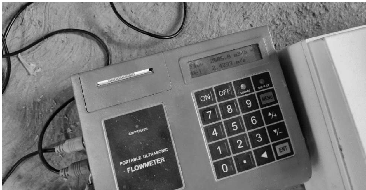
Figura 13. Medición instantánea de caudal de agua en una tubería.
